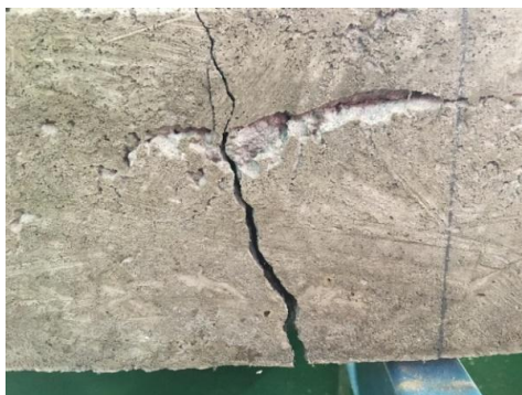
Рис. 6. Вигляд балки Б-1 після руйнування
