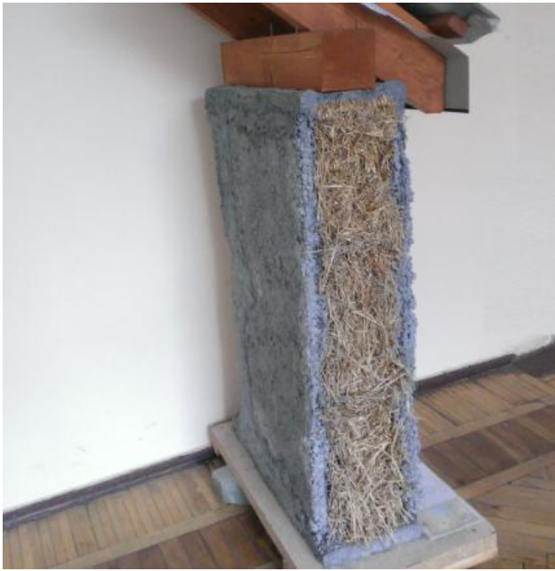
Рис. 2. Фрагмент стіни із солом'яних блоків, зміцненої торкретом
