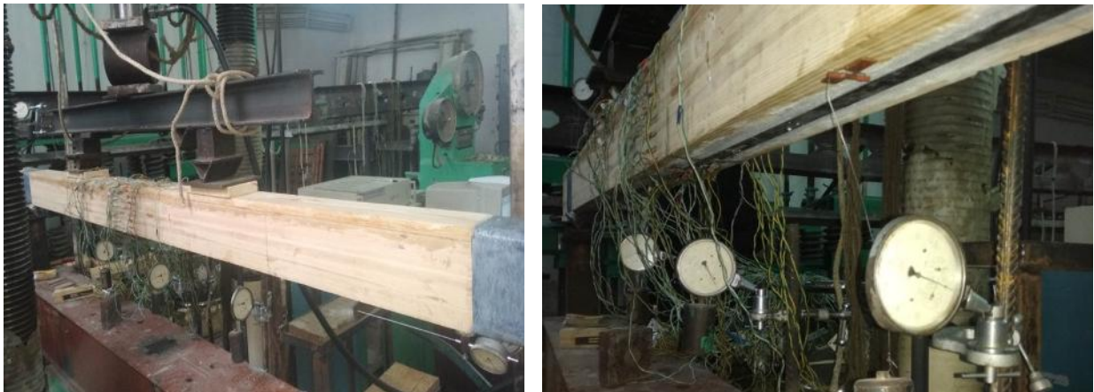
Рис. 5. Загальний вигляд клеєної дерев'яної балки з комбінованим армуванням під навантаженням
