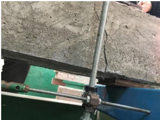
Рис. 8. Загальний вигляд Б-4п після руйнування
