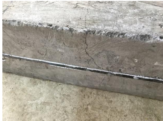
Рис. 7. Вигляд балки Б-2п після руйнування
