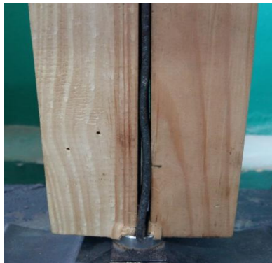
Рис. 3. Характер руйнування металодерев'яного елемента від зминання та втрати стійкості металевій пластині
