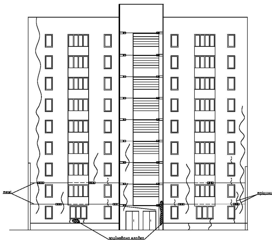
Рис. 5. Тріщини у швах плит перекриття, що переходять на стіни
