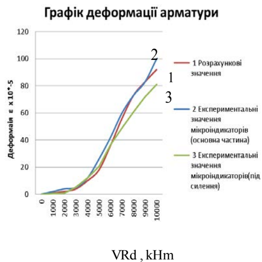
Рис. 5. Графік залежності деформацій арматури Ø 6 мм балки Б-3П.
