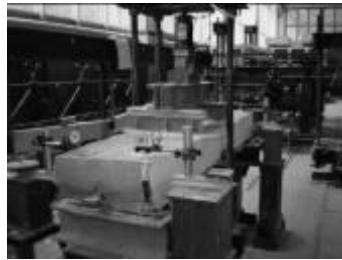
Рис. 2. Вигляд дослідної установки під час випробування коротких збірно-монолітних залізобетонних плит перекриття з використанням безавтоклавного пінобетону на згин.
