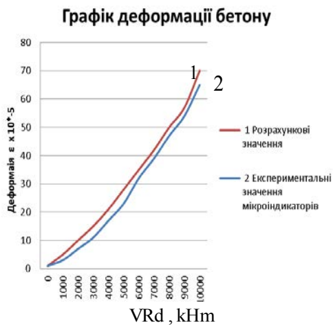
Рис. 4. Графік залежності деформацій на грані основної частини балки Б-3П за бази 180 мм.
