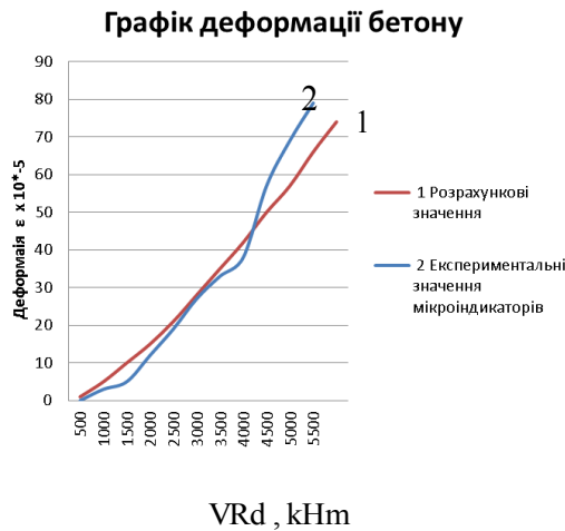
Рис. 2. Графік залежності деформацій бетону балки Б-1 за бази 180 мм.
