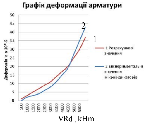
Рис. 3. Графік залежності деформацій арматури Ø 6 мм балки Б-1.
