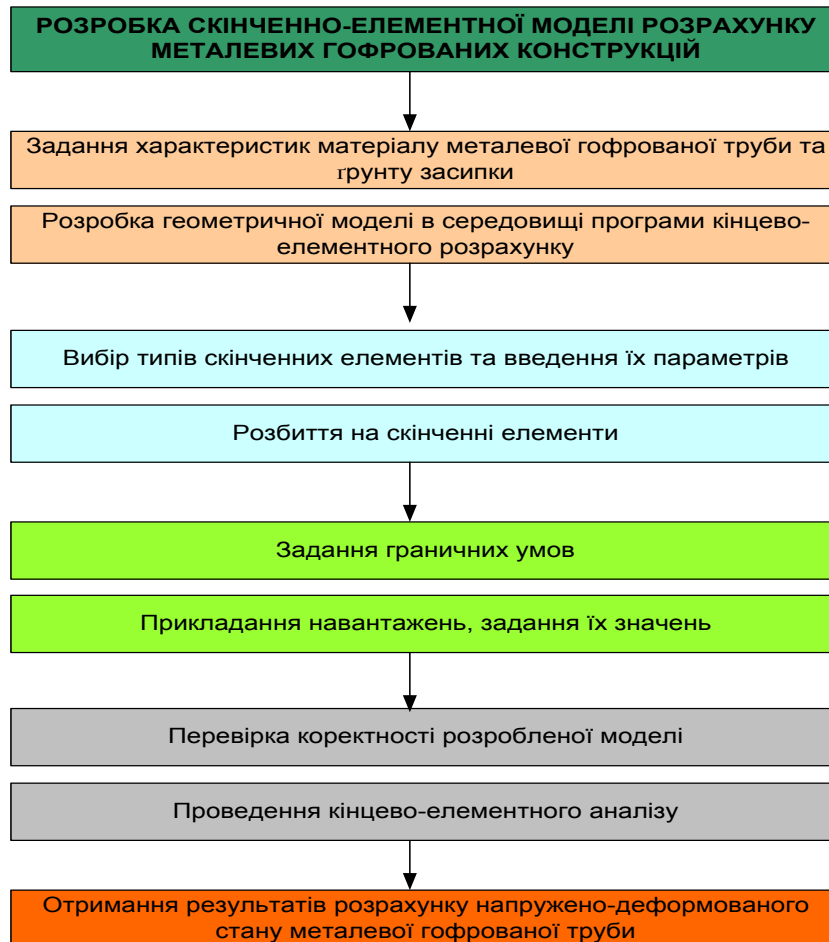
Рис. 1. Схема послідовності розрахунку напружено-деформованого стану металевих гофрованих конструкцій за допомогою МСЕ.
