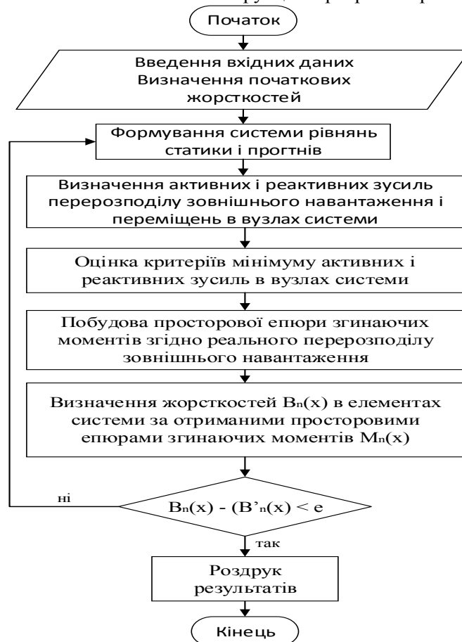
Рис. 2. Блок-схема розрахунку комбінованої металевої конструкції.
