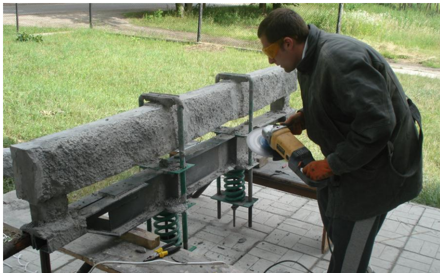
Рис. 3. Підготовка підсиленої балки серії 1 після дозрівання бетону.
