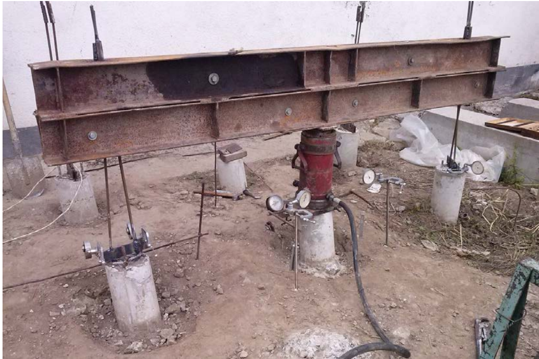
Рис. 1. Загальний вигляд експериментальної установки для випробування паль.
