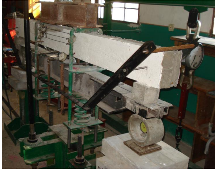
Рис. 4. Дослідний стенд експериментальної балки серії 1.
