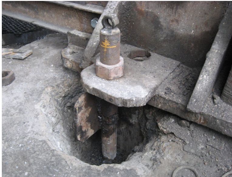
Рис. 8. Розрив анкера приводу.
