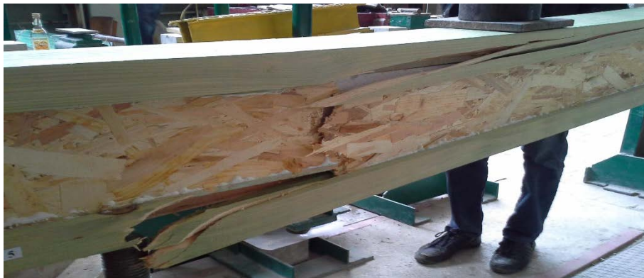
Рис. 7. Місце руйнування стінки та поличок балки Б-2.
