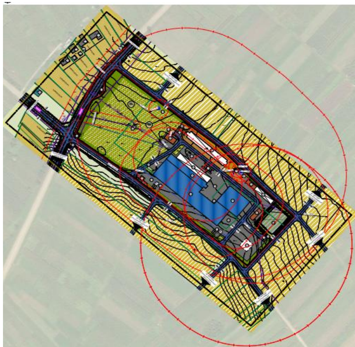
Рис. 3. Проектний план та схема проектних обмежень у використанні земель, поєднані зі схемою транспортної мобільності та інфраструктури М1:1000
