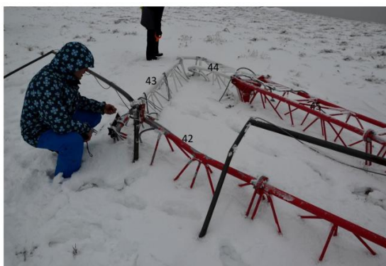
Рис. 11. Розрив 42 секції та згин 44-ї (на передньому плані секція 41)
