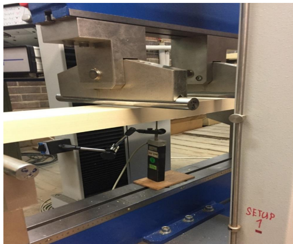
Рис. 8. Вимірювання модуля пружності деревини за допомогою електронної лінійки на випробувальному стенді
