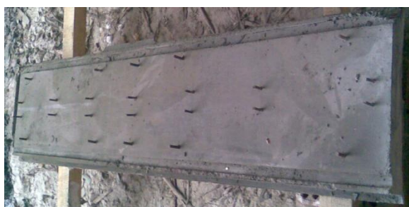
Рис. 2. Торкрет-бетонний масив, підготовлений для розподілу
