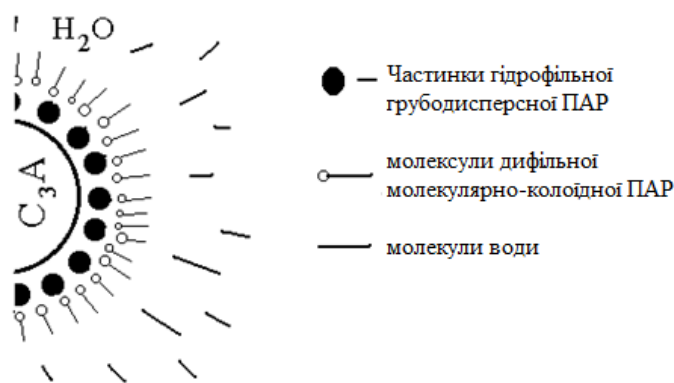
Рис. 2. Схема адсорбції на поверхні трикальцієвого алюмінату компонентів комплексної ПАР
