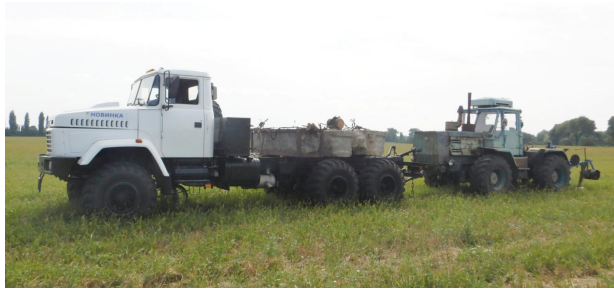
Рис. 2. Тягові випробування МЕЗ-330 «Авто-трактор» Fig. 2. Traction tests MEZ-330 «Autotractor»
