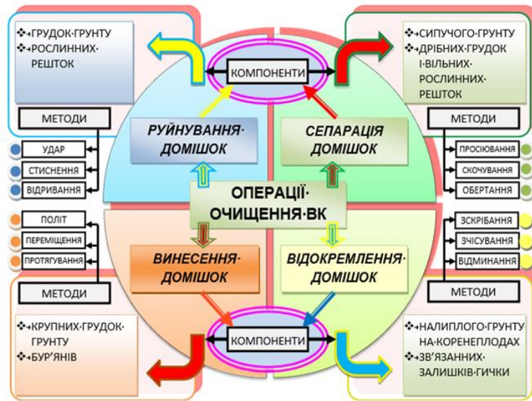
Рис. 2. Схема операцій очищення вороху коренеплодів Fig. 2. Scheme of operations for cleaning the rocks of root crops
