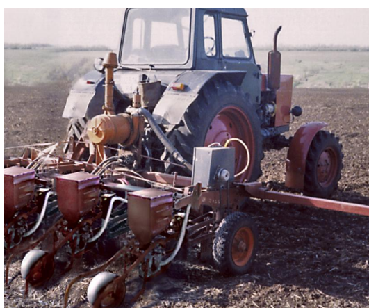
Рис. 9. Посівна машина з висівними апаратами пунктирної сівби на основі елементів пневмоніки на польових випробуваннях
