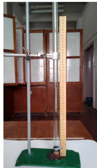
Рис. 10. Стенд для дослідження міцності шкаралупи горіхів і початку їх руйнування: 1 – станина; 2 – підставка; 3 – напрямна трубка; 4 – лінійка; 5 – тягарець; 6 – линва; 7 – поліспаст; 8 – котушка з фіксатором; 9 – штатив; 10 – дослідний зразок Fig. 10. Stand for researching the strength of the shells of nuts and the beginning of their destruction: 1 – bed; 2 – stand; 3 – guide tube; 4 – ruler; 5 – burden; 6 – polyspast; 7 – polyspast; 8 – a coil with a lock; 9 – tripod; 10 – test sample
