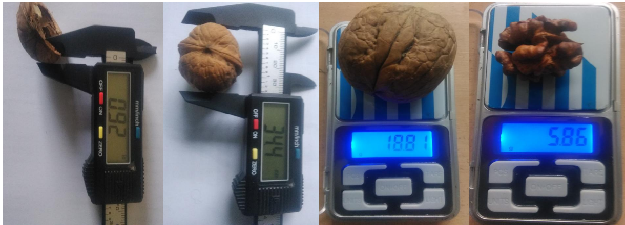
Рис. 1. Вимірювання розмірних і масових показників горіха і ядра Fig. 1. Measurement of dimensional and mass parameters of the nut and kernel
